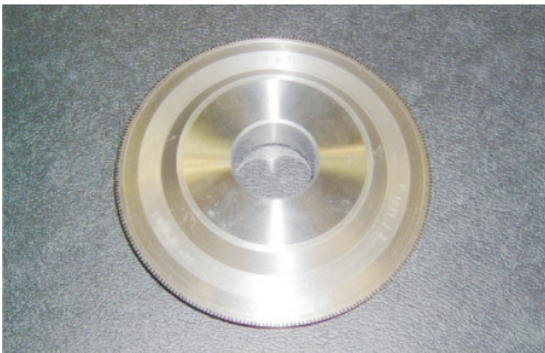
CVD 修砂器 CVD dressing roll R=0,03mm/W=38°
